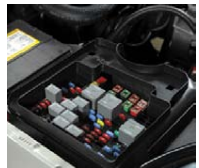
C. Tablero de relevadores del vehículo
